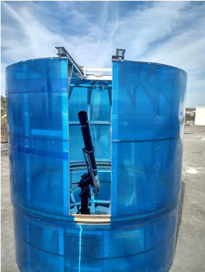
**Gambar 2.** Kombinasi instrumen setelah terpasang di dalam rumah teleskop.
