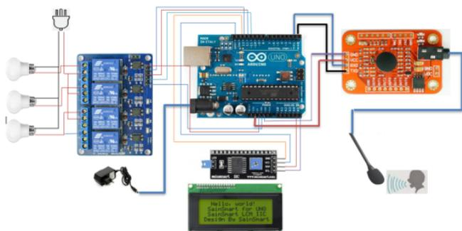
Gambar 8. Skematik Alat Pengenalan Suara
